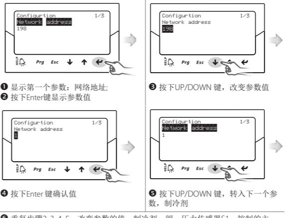
重复步骤2, 3, 4, 5, 改变参数的值: 制冷剂, 阀, 压力传感器S1, 控制的主要类型;
