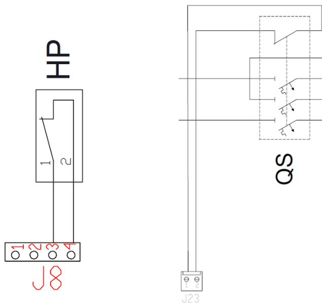
Новое подключение датчика высокого давления и автоматического выключателя
