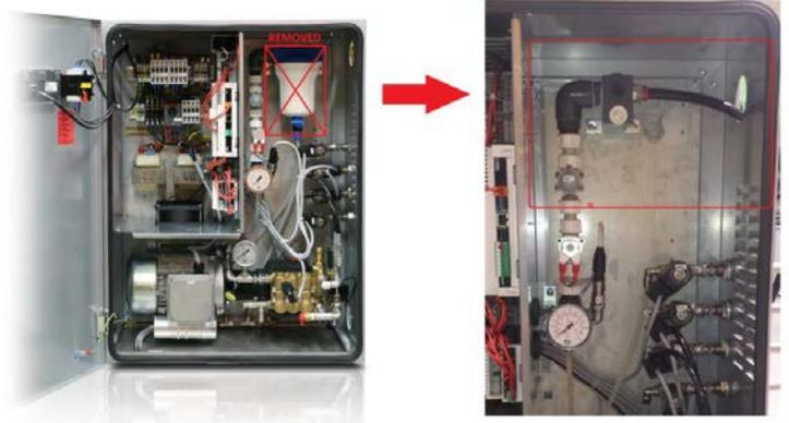
Конструкция щита с серийным номером начиная с A00001812
